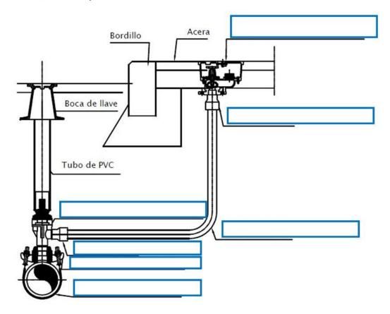
PREGUNTA 8- Indica las partes de una sección tipo de zanja en calzada para una canalización de abastecimiento de agua potable del Ayuntamiento de Salamanca (MÁXIMO 1,00 PUNTO)
